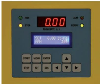
Semplice ed intuitivo consente di impostare il funzionamento della macchina con poche pressioni dei tasti. Un display LCD alfanumerico rende l'impostazione dei parametri un'operazione facile per l'operatore. La portata istantanea è mostrata in modo continuo su un display a LED rossi facilmente leggibile a distanza.
